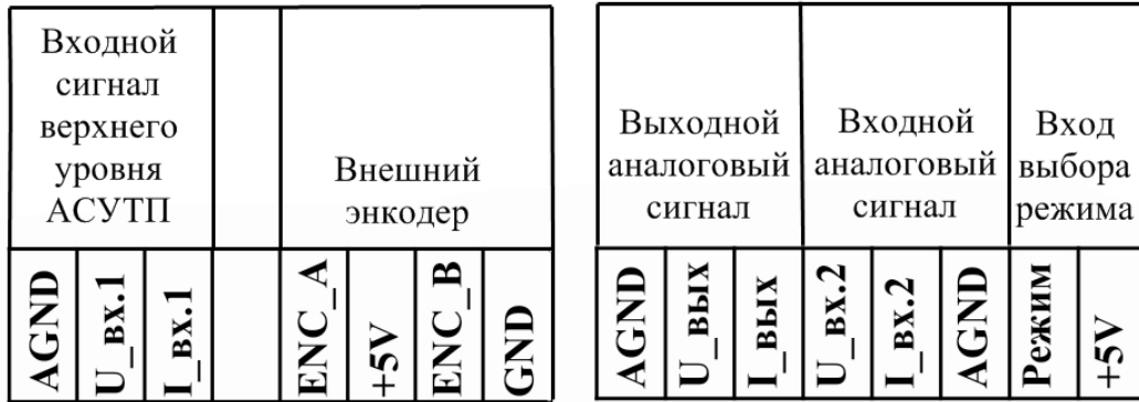
Рис. 2. Схема подключения внешних цепей к верхнему ряду разъемов 3U
